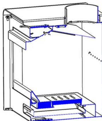
Figura n°14 - Estrarre il resto delle vermiculite
