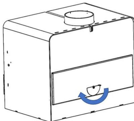
Figura n°11 - Apertura di entrata dell'aria di doppia combustione chiuso
