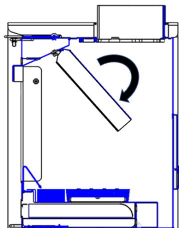
Figura n°15 - Ruotare e rimuovere il deflettore superiore in acciaio
