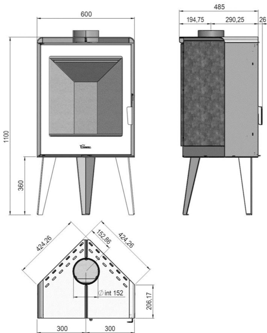
Figura n°2 - Dimensioni in mm dell'apparecchio Ocean / Atlantic 610R
