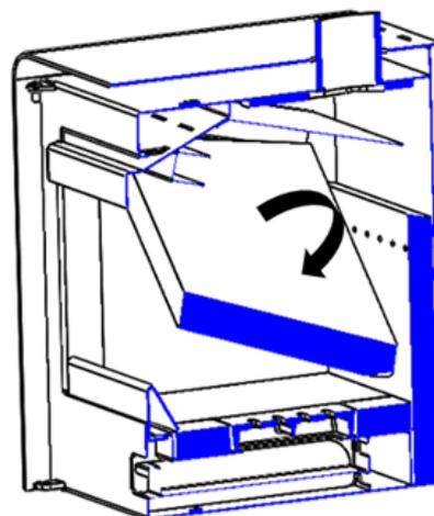
Figura n°13 - Estrazione dei deflettori in vermiculite
