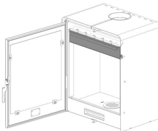
*Figura n°7 - Accessorio ausiliario in caso di riflusso causato da un'installazione difettosa*
