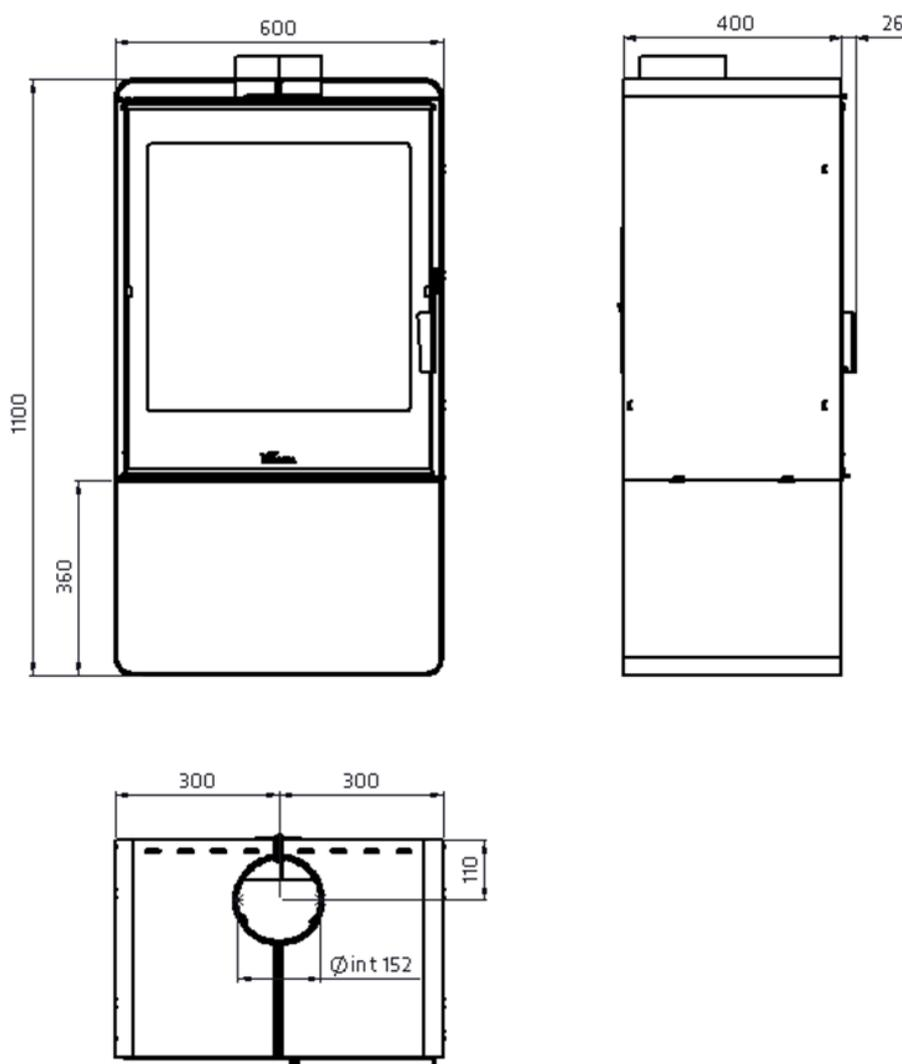
Figura n°1 - Dimensioni in mm dell'apparecchio Ocean / Atlantic 610
