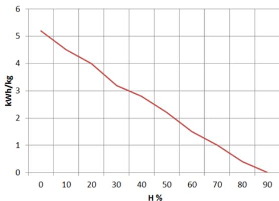
Figura n°8 - Rapporto tra umidità e potere calorifico della legna.
