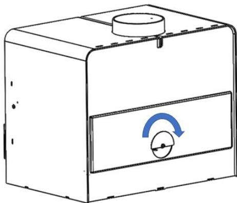
Figura n°10 - Apertura di entrata dell'aria di doppia combustione aperto
