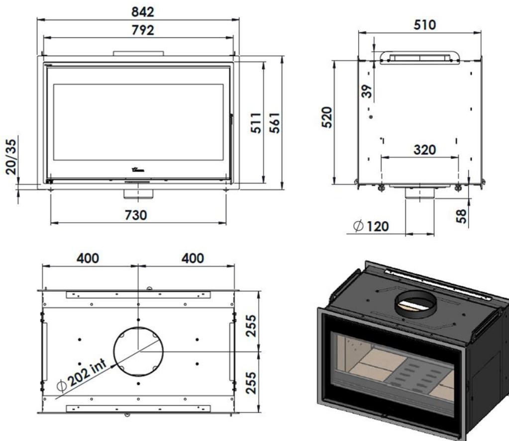
Figura n°2 - Dimensioni in mm dell'apparecchio Nickel 800
