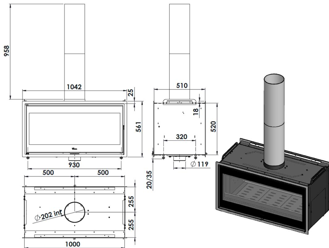
Figura n°3 - Dimensioni in mm dell'apparecchio Nickel 1000
