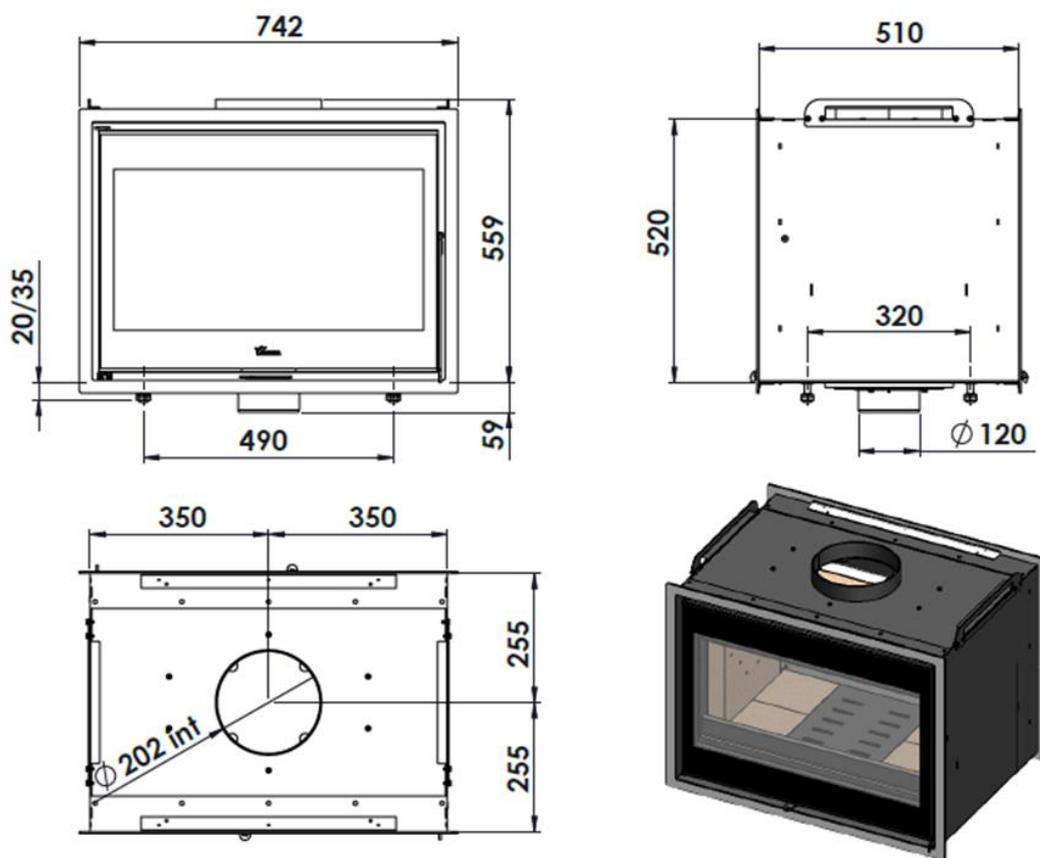
Figura n°1 - Dimensioni in mm dell'apparecchio Nickel 700
