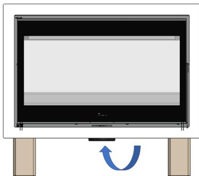
Figura n°5 - Entrata dell'aria per la combustione
