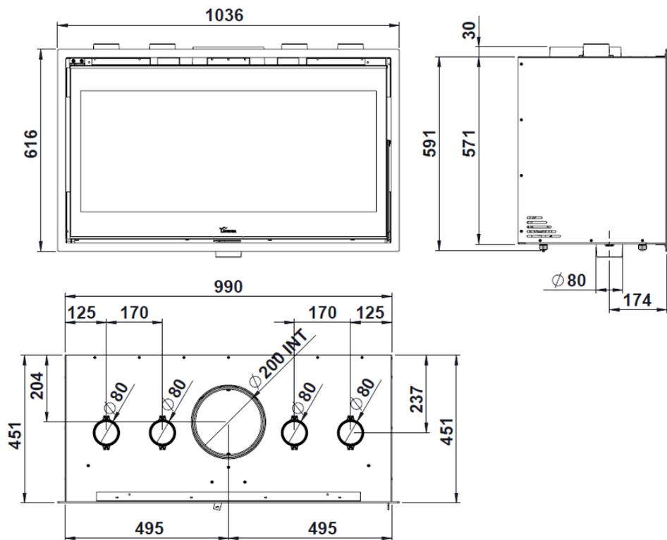
Figura n°3 - Dimensioni in mm dell'apparecchio LOIRE 1000
