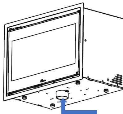
Figura n°7 - l'aria per la combustione direttamente dall'esterno
