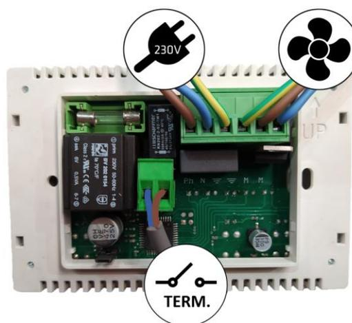
Figura n°16 - Collegamenti da realizzare nel potenziometro
