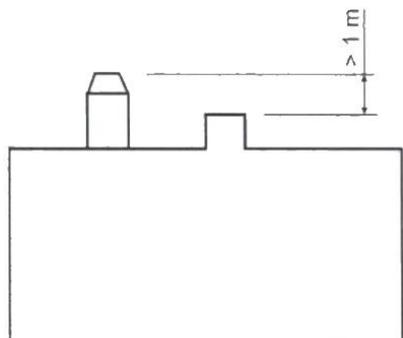
Figura n°17 - Distanza tra la finitura e il colmo del tetto
