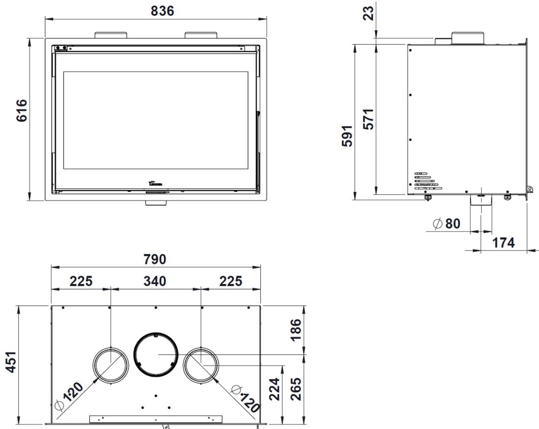
Figura n°2 - Dimensioni in mm dell'apparecchio LOIRE 800
