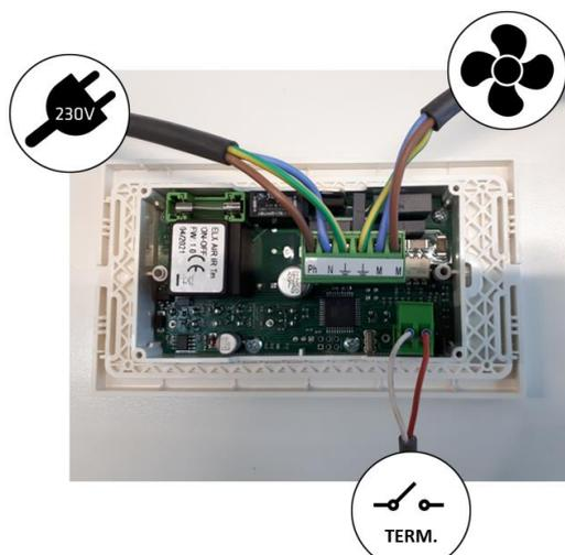
Figura n°13 - Collegamenti da realizzare nel potenziometro
