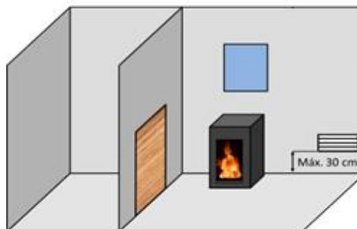
Figura n°3 - Schema orientativo per griglie di ventilazione
