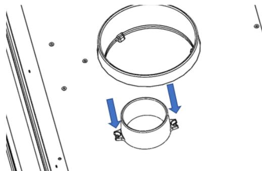
Figura n°10 - Bocchetta correttamente avvitata nei 2 punti con le sue rondelle
