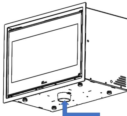
*Figura n°6 - l'aria per la combustione direttamente dall'esterno*
