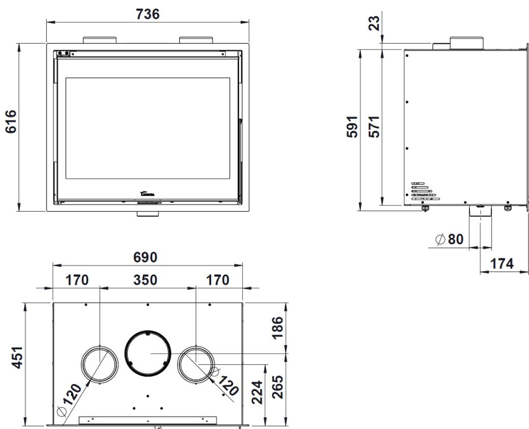
Figura n°1 - Dimensioni in mm dell'apparecchio LOIRE 700
