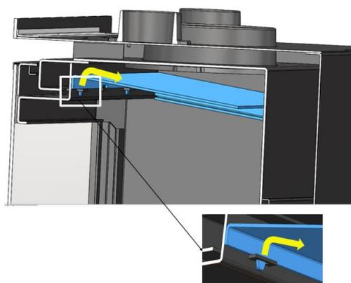
*Figura n°21 - Smontaggio del deflettore superiore in acciaio*
