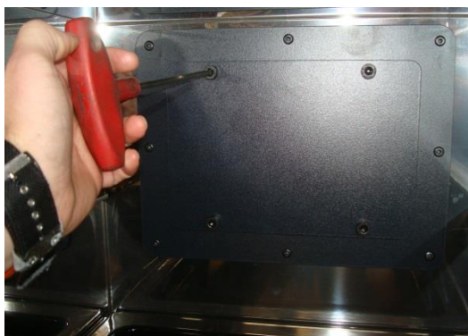
Figura n°15 - Accesso alle viti per rimuovere la copertura del sportello
