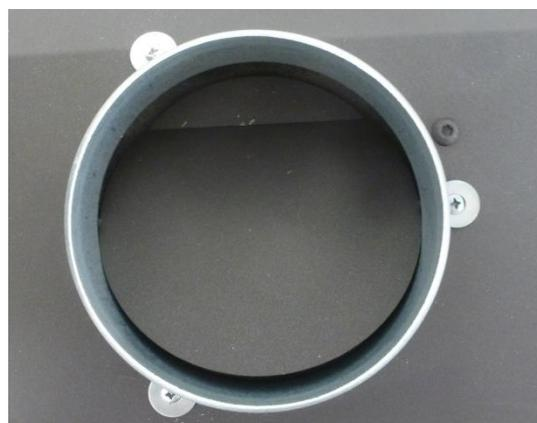
*Figura n°8 - Bocchetta correttamente avvitata nei 3 punti con le sue rondelle*
