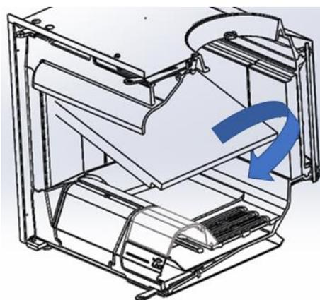
Figura n°28 - Estrazione dei deflettori in vermiculite
