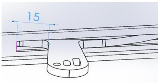
Figura n°21 - entrata dell'aria secondaria aperto 15 mm
