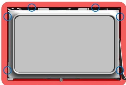
*Figura n°11 - Punti di fissaggio delle viti*
