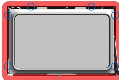
*Figura n°12 - Ubicazione delle 6 linguette da piegare*
