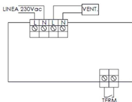
Figura n°15 - Collegamenti da realizzare nel potenziometro della turbina
