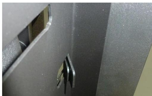
*Figura n°14 - Particolare della linguetta piegata*
