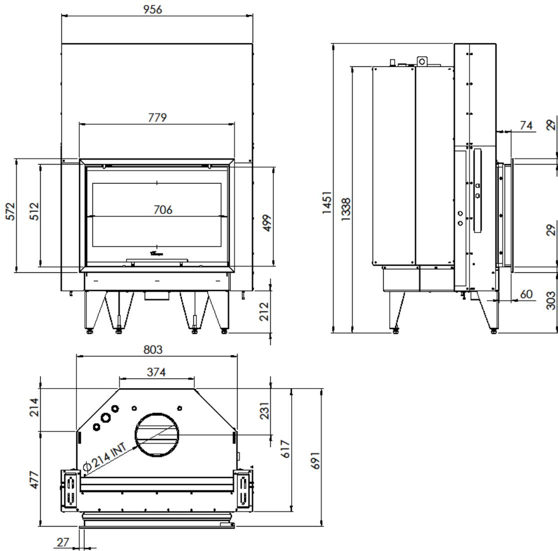
Figura n°2 - Dimensioni in mm dell'apparecchio Itaca 80 hidro R18
