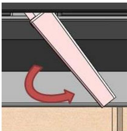
*Figura n°27 - Girare il perno in senso antiorario*
