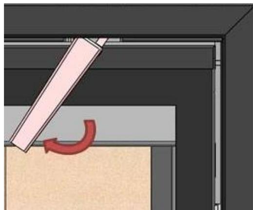
*Figura n°28 - Girare il perno destro in senso orario*
