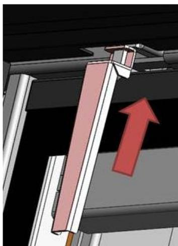
*Figura n°26 - Inserire l'utensile per i perni apertura pulizia vetro porta*
