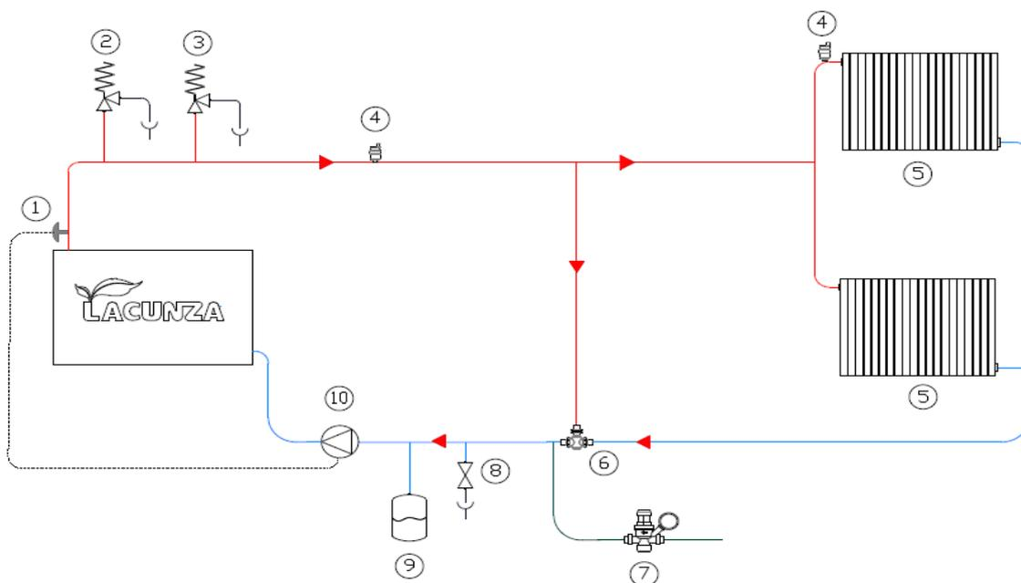
Quando l'acqua del serbatoio raggiunge i 50°C, il termostato (1) metterà in funzione la pompa di circolazione (10), fino a quando la temperatura non scenda al disotto di tale valore.
