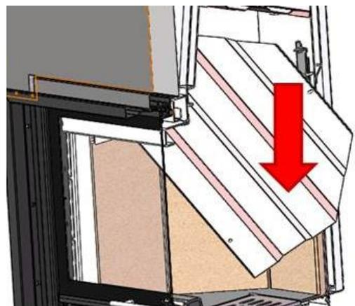
Figura n°23 - Smontaggio del deflettore inferiore
