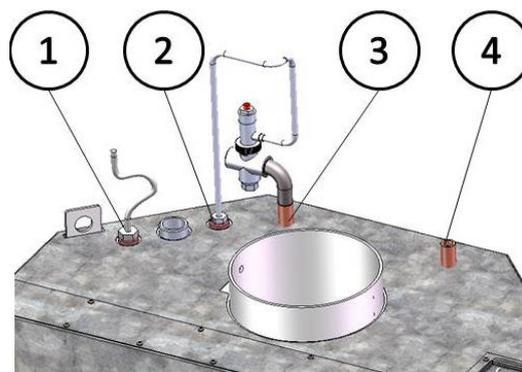
Figura n°17 - Raccordi di collegamento del serbatoio
