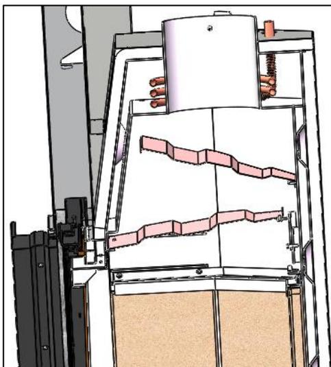
Figura n°20 - Vista in sezione con i 2 deflettori collocati
