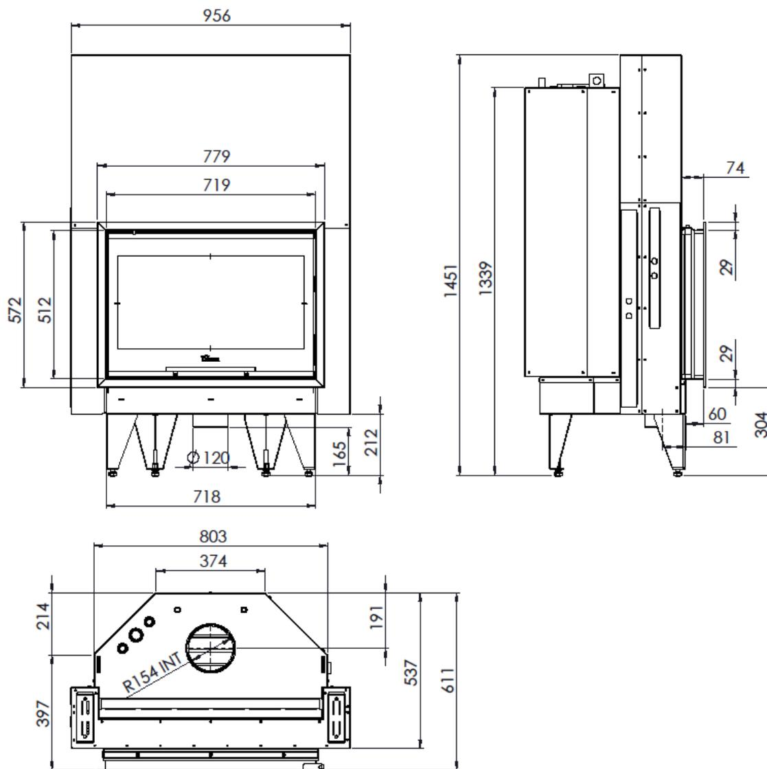
Figura n°1 - Dimensioni in mm dell'apparecchio Itaca 80 hidro R12
