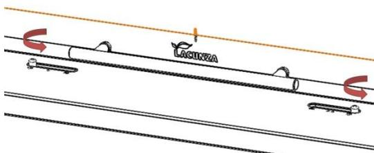
Figura n°9 - Svitare i 2 perni delle aperture 1<sup>a</sup> e 2<sup>a</sup>
