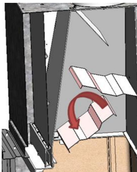
Figura n°28 - Smontaggio del deflettore intermedio Itaca 80
