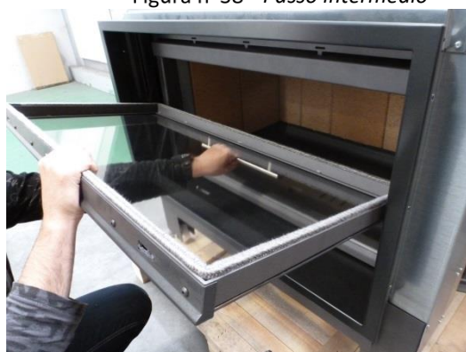
Figura n°39 - Porta completamente reclinata
