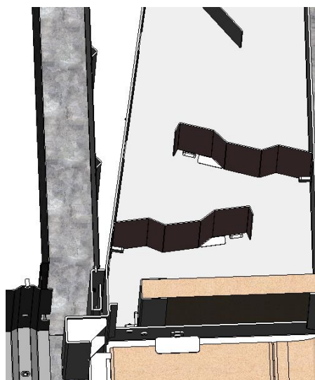
Figura n°24 - Vista in sezione Itaca 80 con i deflettori collocati
