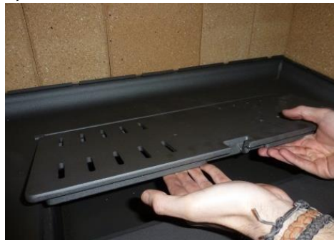
Figura n°23 - Reclinare la griglia con entrambe le mani
