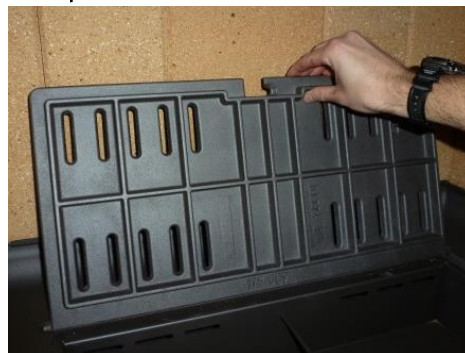
Figura n°24 - Appoggiare la griglia sul fondo del focolare
