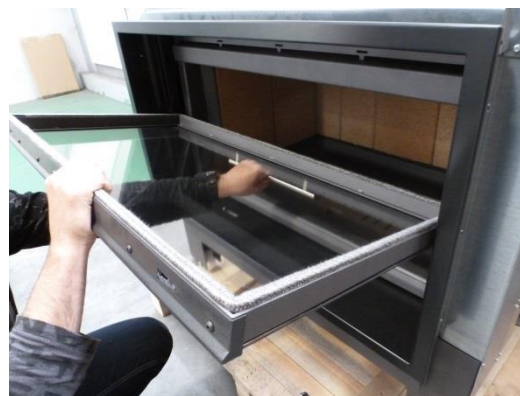
Figura n°39 - Porta completamente reclinata
