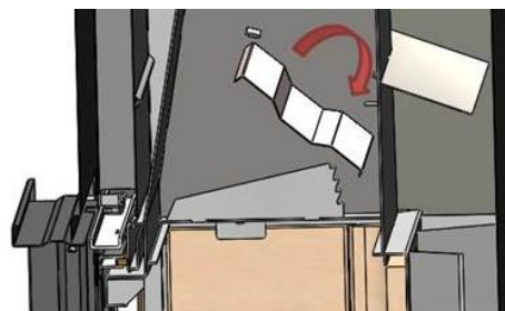
Figura n°26 - Smontaggio del deflettore intermedio Inca
