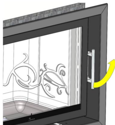
Figura n°27 - Apertura della porta Inca
