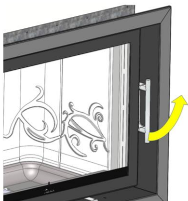
Figura n°27 - Apertura della porta Inca
