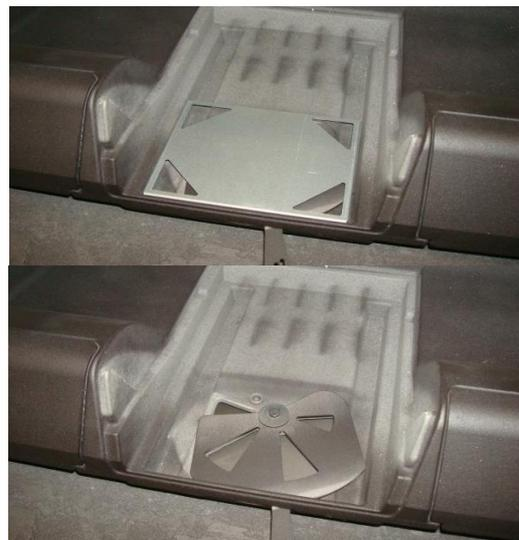
*Figura n°23 - Sequenza di smontaggio dei pezzi per la pulizia*
