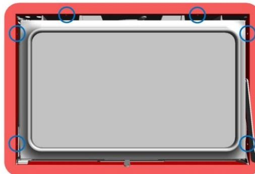
Figura n°10 - Punti di fissaggio delle viti
