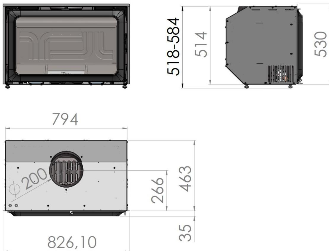
Figura n°1 - Dimensioni in mm dell'apparecchio IF-800
