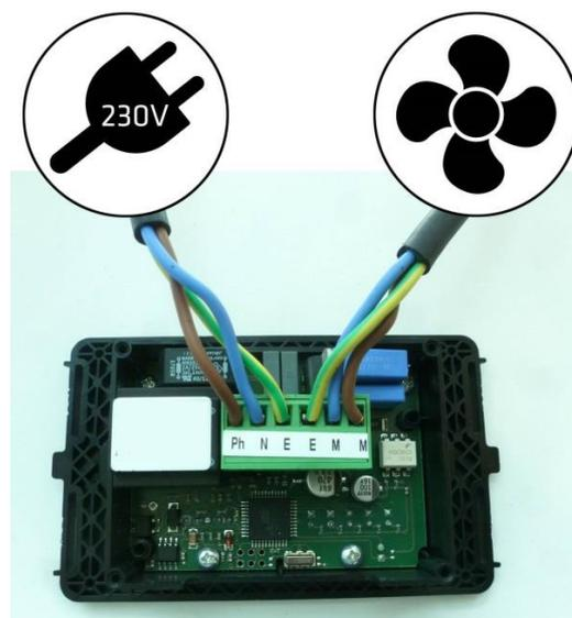
Figura n°14 - Collegamenti da realizzare nel potenziometro
