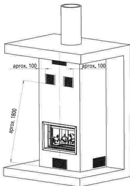
Figura n°4 - Schema esterno del rivestimento
