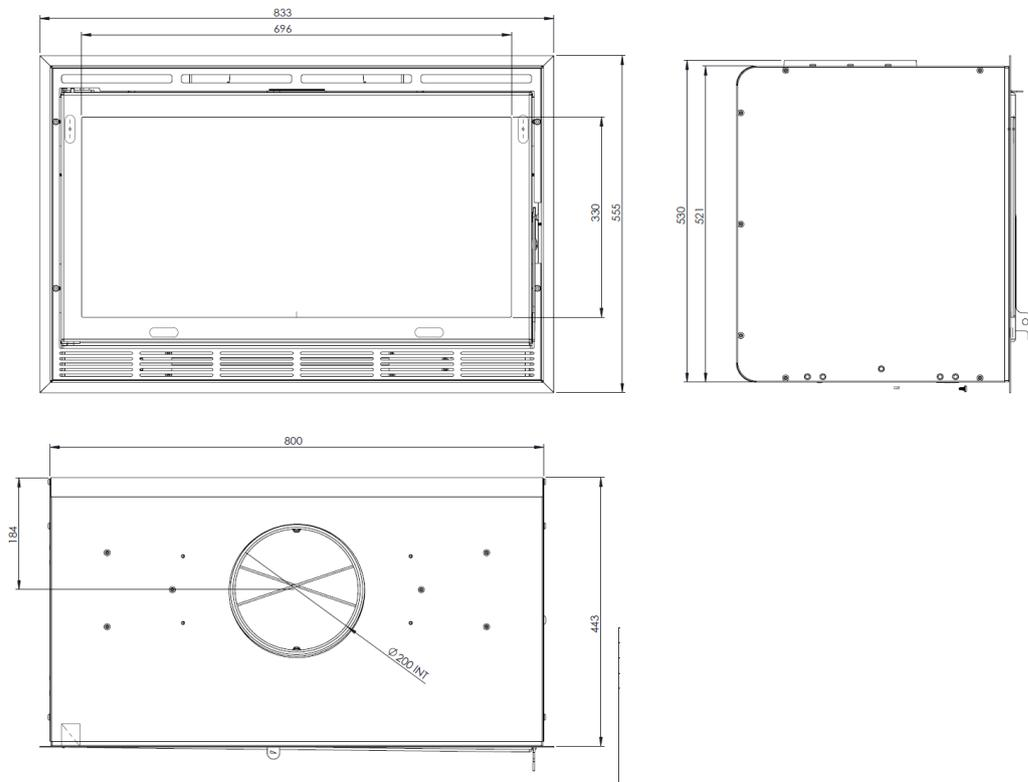
Figura n°2 - Dimensioni in mm dell'apparecchio IC-800 AROA 800
