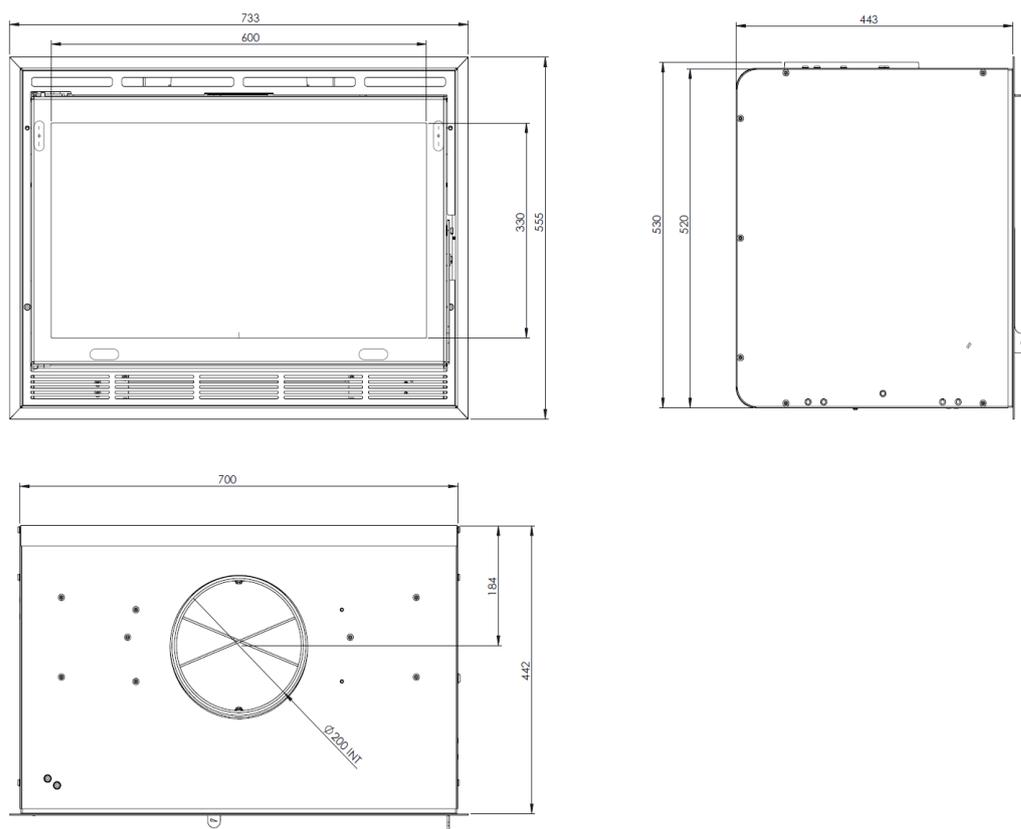
Figura n°1 - Dimensioni in mm dell'apparecchio IC-700 AROA 700
