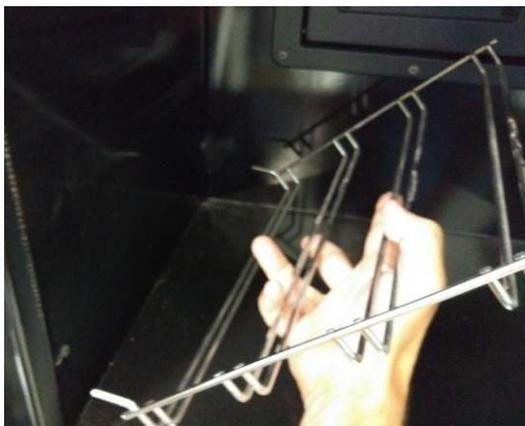
*Figura n°23 - Rimozione dei portacanne*
