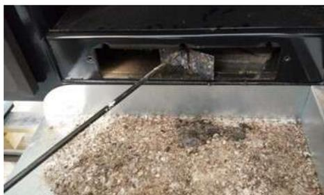
*Figura n°22 - Accessi per la pulizia dello scarico fumi.*
