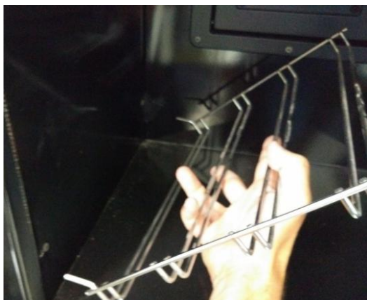
Figura n°23 - Estrazione delle barre di supporto.
