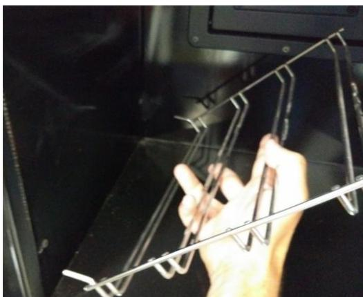
*Figura nº22 - Estrazione delle barre di supporto.*
