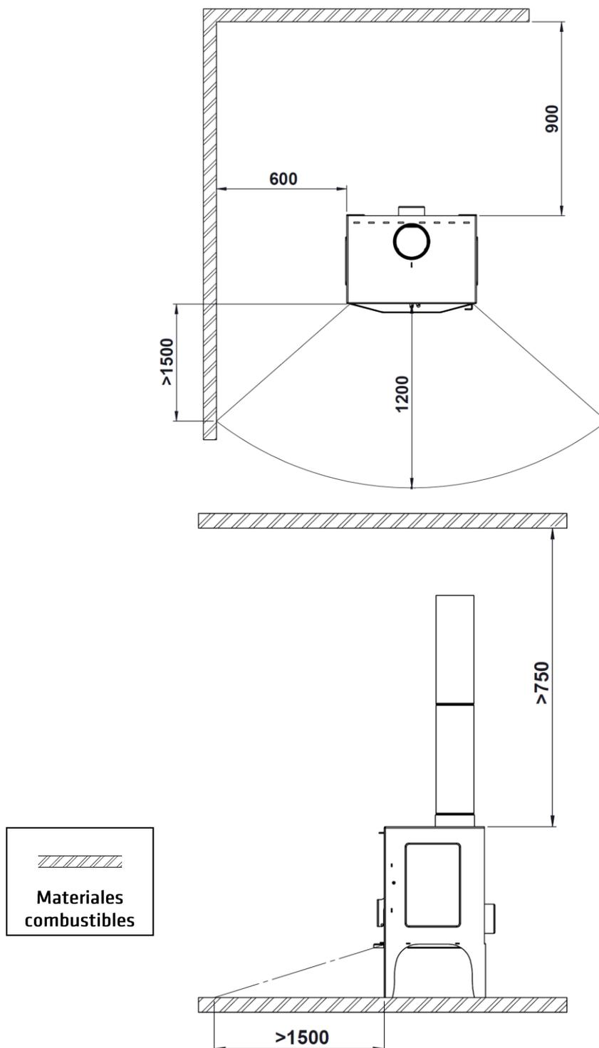
Tenere presente che può essere necessario proteggere anche i materiali non combustibili, per evitare rotture, deformazioni, ecc., per eccesso di temperatura, se il materiale non combustibile non è preparato per sopportare alte temperature.
