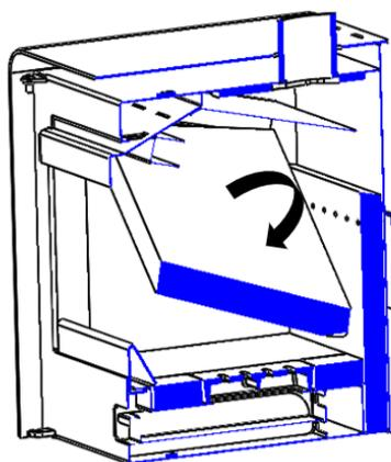
Figura n°12 - Estrazione dei deflettori in vermiculite
