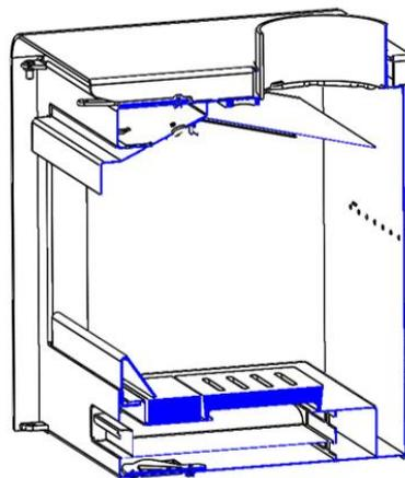
Figura n°13 - Estrarre il resto delle vermiculiti
