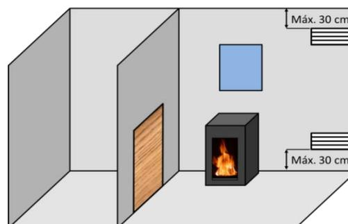
Figura nº2 - Schema orientativo per griglie di ventilazione
