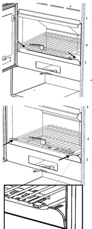
Figura n°13 - Collocazione della griglia nel forno
