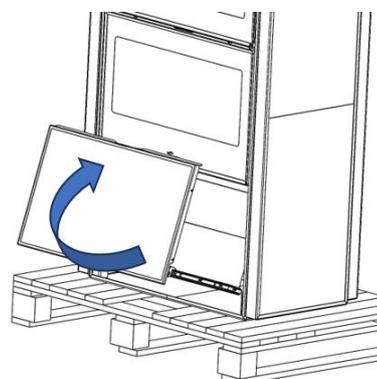
Figura n°4 - Dettaglio della rimozione del cassetto
