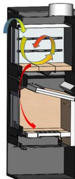
Figura n°11 - Schema sistema di estrazione di vapore
