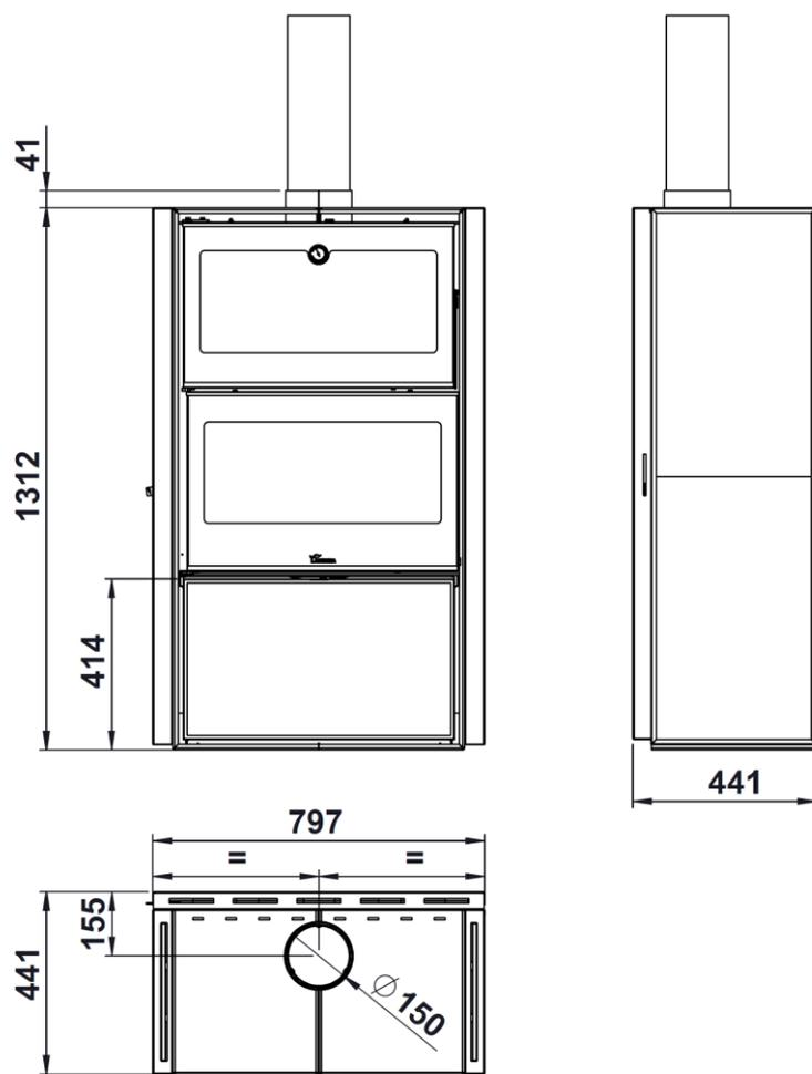
Figura n°1 - Dimensioni in mm dell'apparecchio BERGEN
