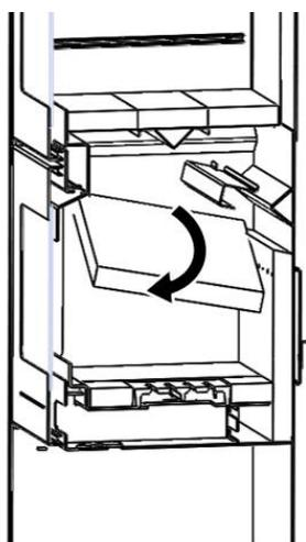
Figura n°17 - *Estrazione dei deflettori in vermiculite*
