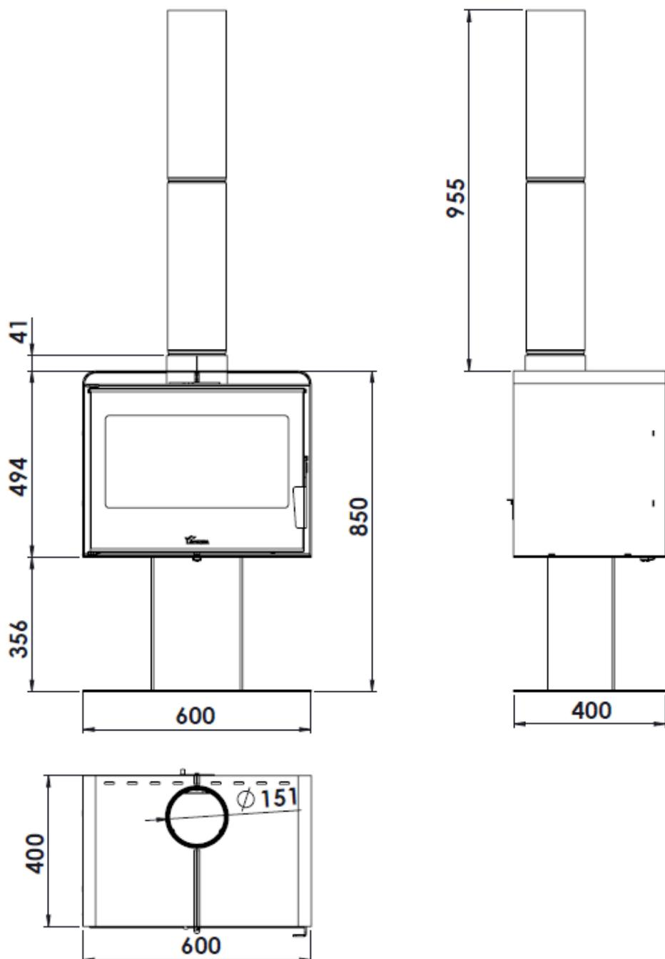
Figura n°1 - Dimensioni in mm dell'apparecchio serie Atlantic 600
