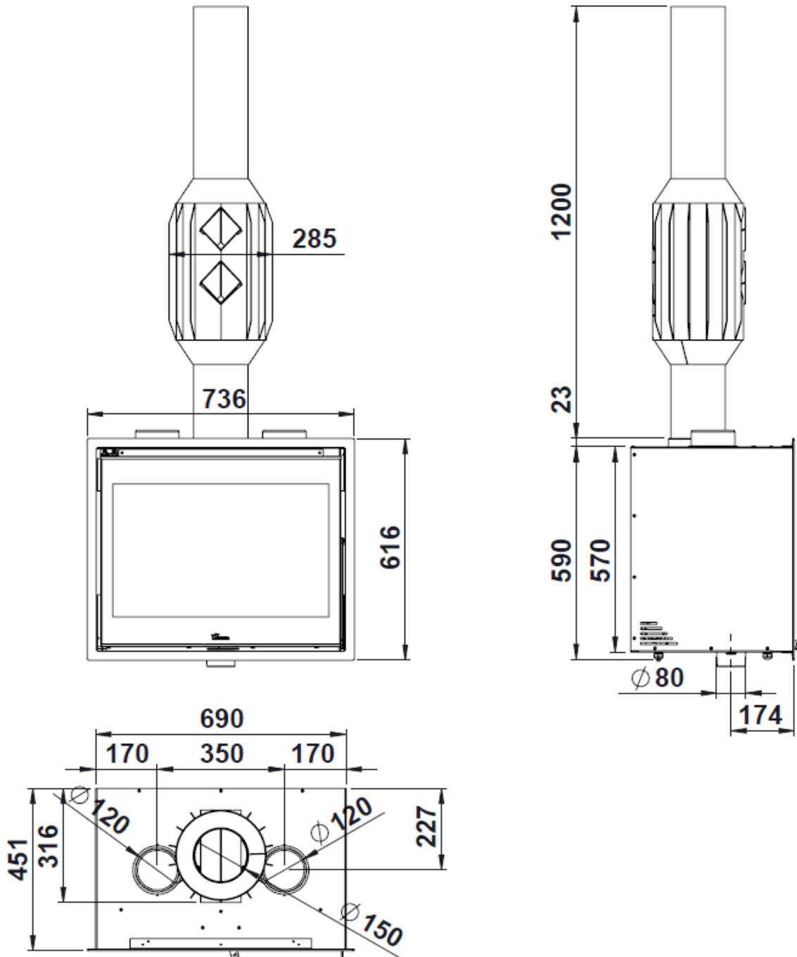
Figura n°6 - Dimensioni in mm dell'apparecchio LOIRE 700 EX150
