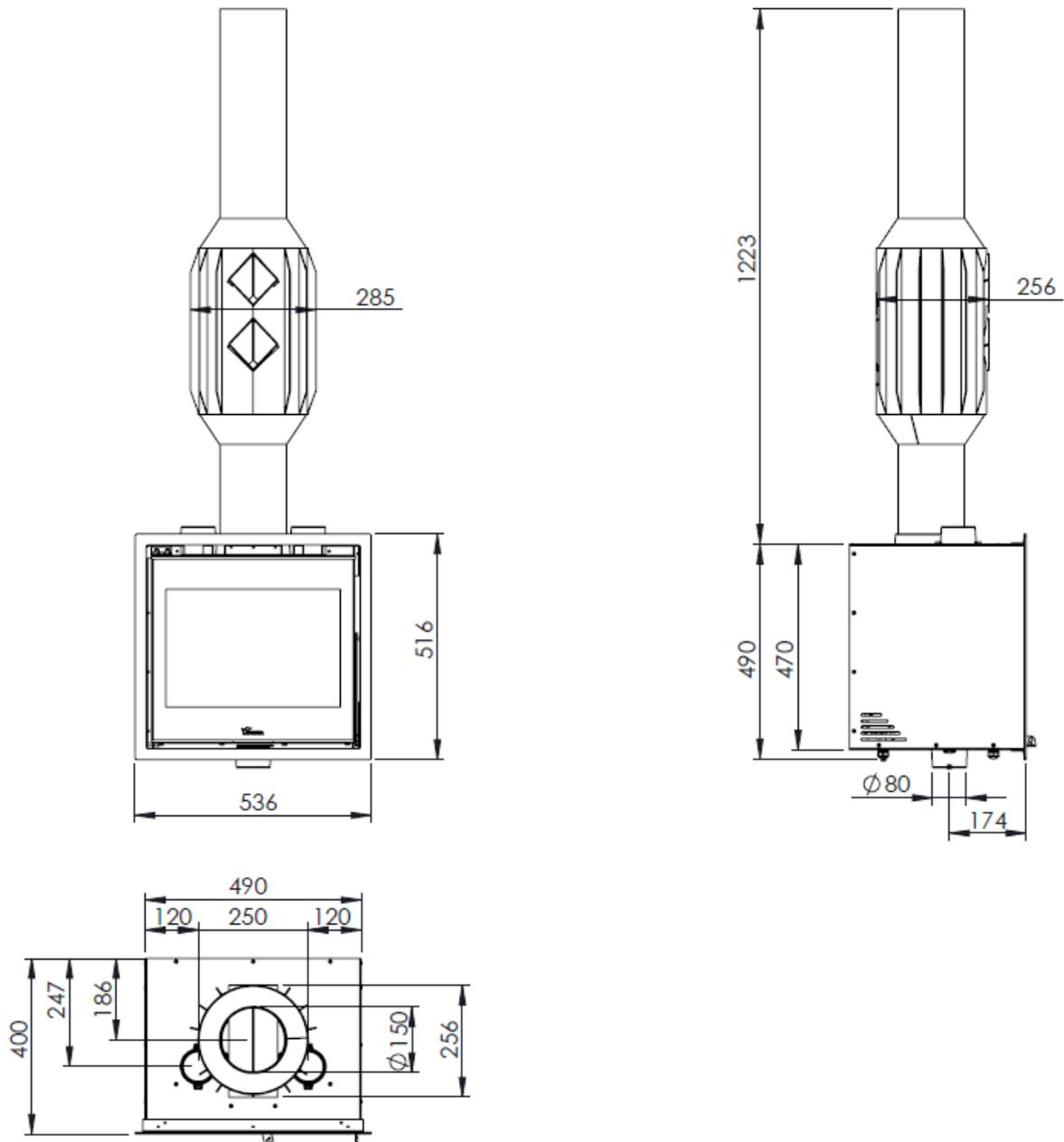
Figura n°1 - Dimensioni in mm dell'apparecchio ADOUR 500 EX150
