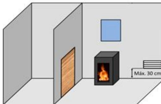
Figura n°8 - Schema orientativo per griglie di ventilazione
