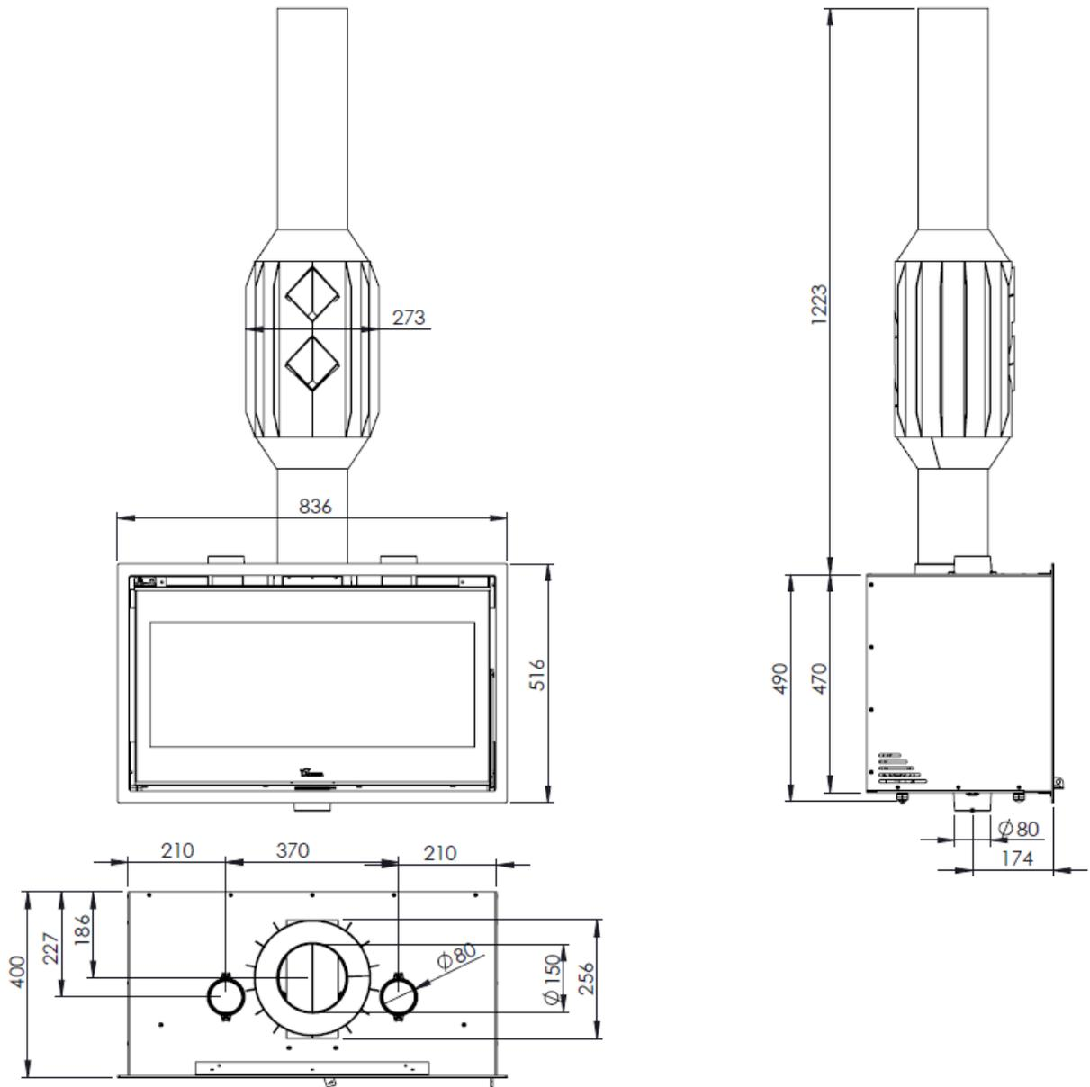
Figura n°4 - Dimensioni in mm dell'apparecchio ADOUR 800 EX150
