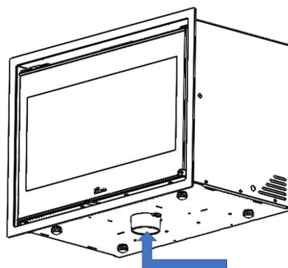
*Figura n°11 - l'aria per la combustione direttamente dall'esterno*
