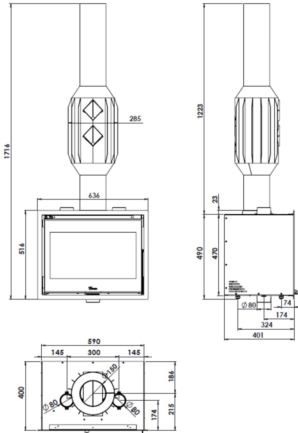
Figura n°2 - Dimensioni in mm dell'apparecchio ADOUR 600 EX150
