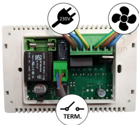
Figura n°21 - Collegamenti da realizzare nel potenziometro
