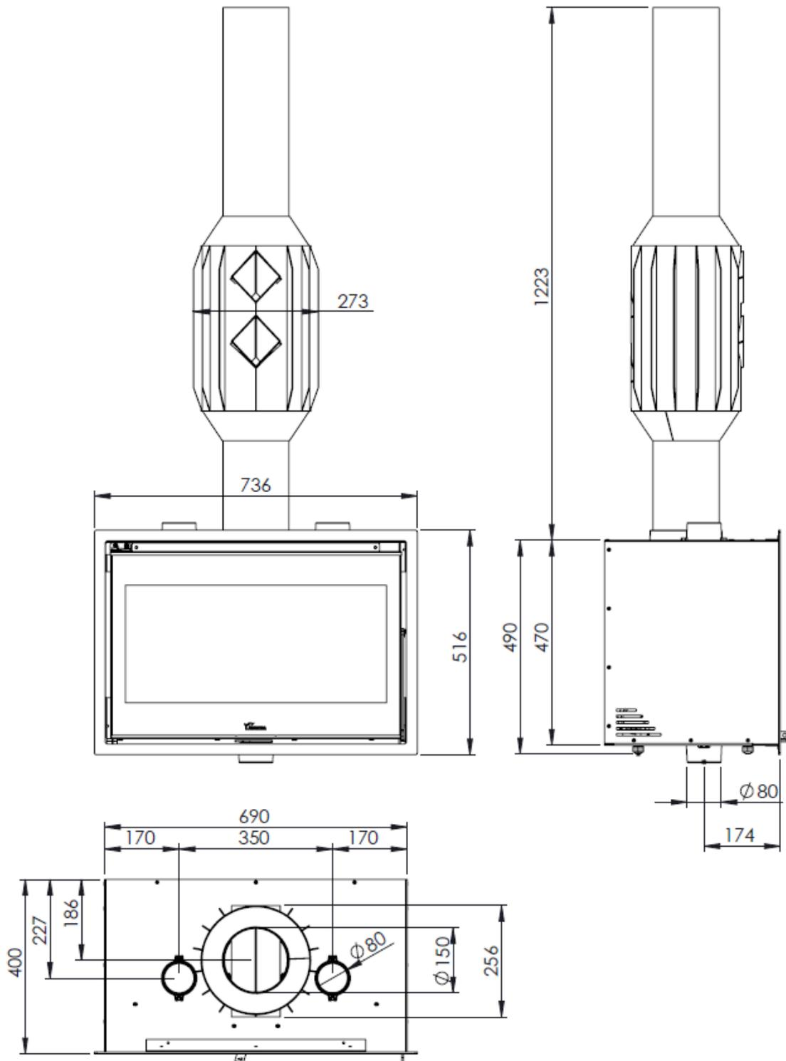
Figura n°3 - Dimensioni in mm dell'apparecchio ADOUR 700 EX150
