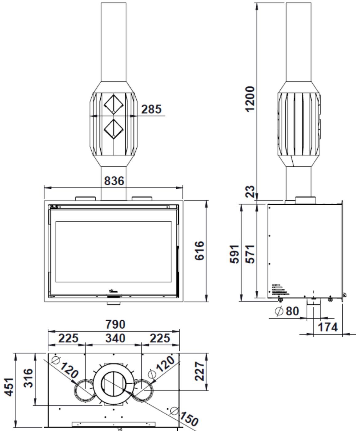
Figura n°7 - Dimensioni in mm dell'apparecchio LOIRE 800 EX150
