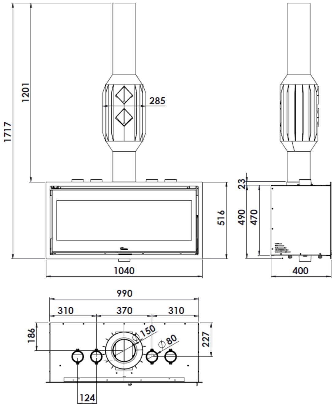
Figura n°5 - Dimensioni in mm dell'apparecchio ADOUR 1000 EX150
