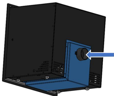
Figura n°10 - Accessorio per incanalare l'ingresso dell'aria dalla parte posteriore
