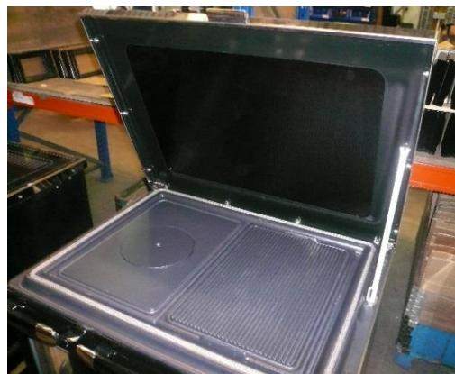
Figura nº28 - Proteções debaixo da placa vitrocerâmica
