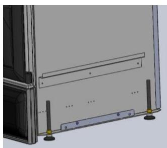
Figura n°6 - Patas para a regulação da altura do aparelho
