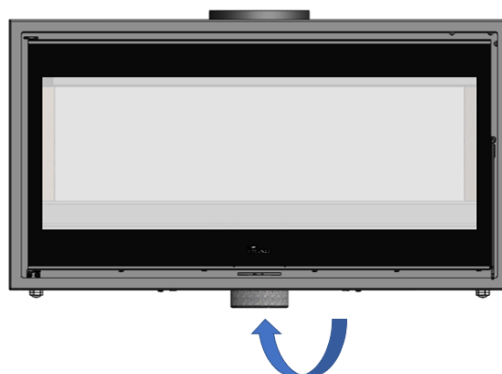
Figura nº8 - Condução do ar para a câmara de combustão Verona 800-1000
