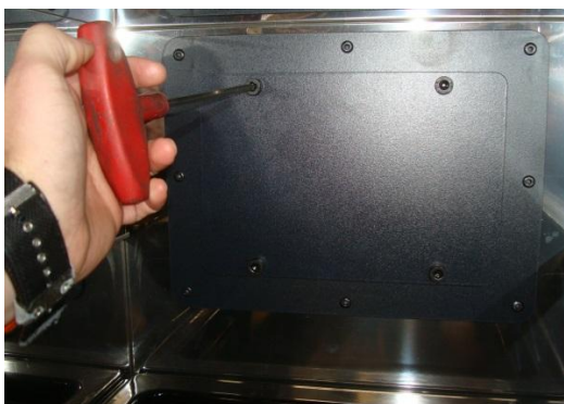
Figura nº20 - Acesso aos parafusos para retirar a tampa da escotilha
