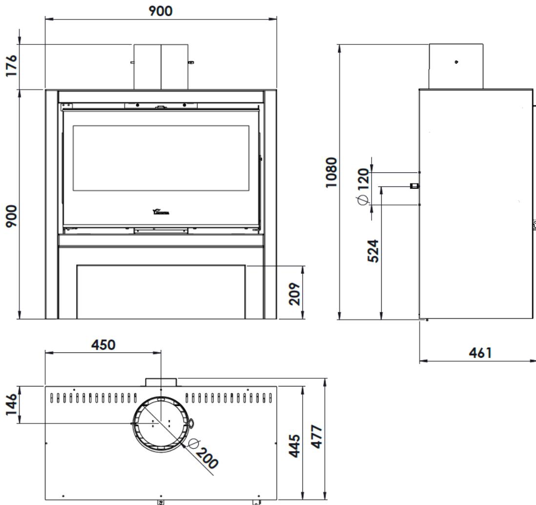
Figura nº1 - Dimensões em mm do aparelho PLATINUM 800
