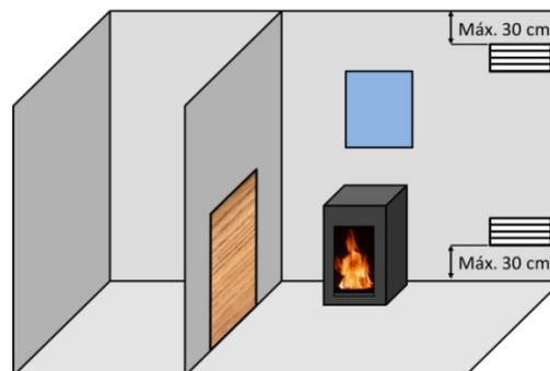
Figura nº2 - Esquema orientativo para grelhas de arejamento
