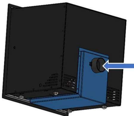
Figura nº13 - Acessório para canalizar a entrada de ar pela parte traseira
