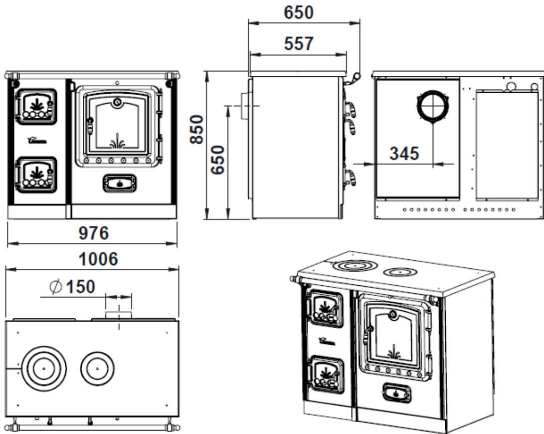
Figura n°3 - Dimensões em mm do aparelho Lis 8T
