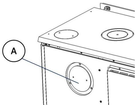
*Figura n°6 - Retirar a peça A*
