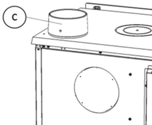
*Figura n°8 - Esquema para saída de fumos superior*
