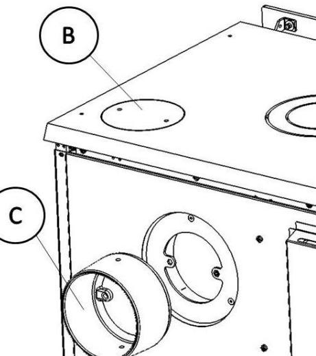
*Figura n°7 - Esquema para saída de fumos traseira*
