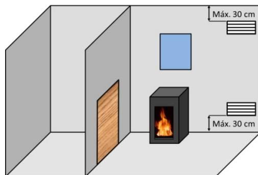
Figura n°4 - Esquema orientativo para grelhas de arejamento
