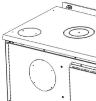
*Figura n°5 - Retirar a peça galvanizada*
