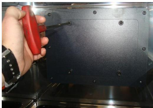
Figura nº17 - Acesso aos parafusos para retirar a tampa da escotilha
