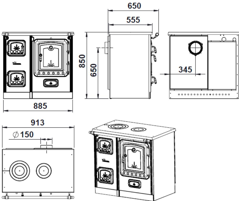
Figura n°2 - Dimensões em mm do aparelho Lis 7T
