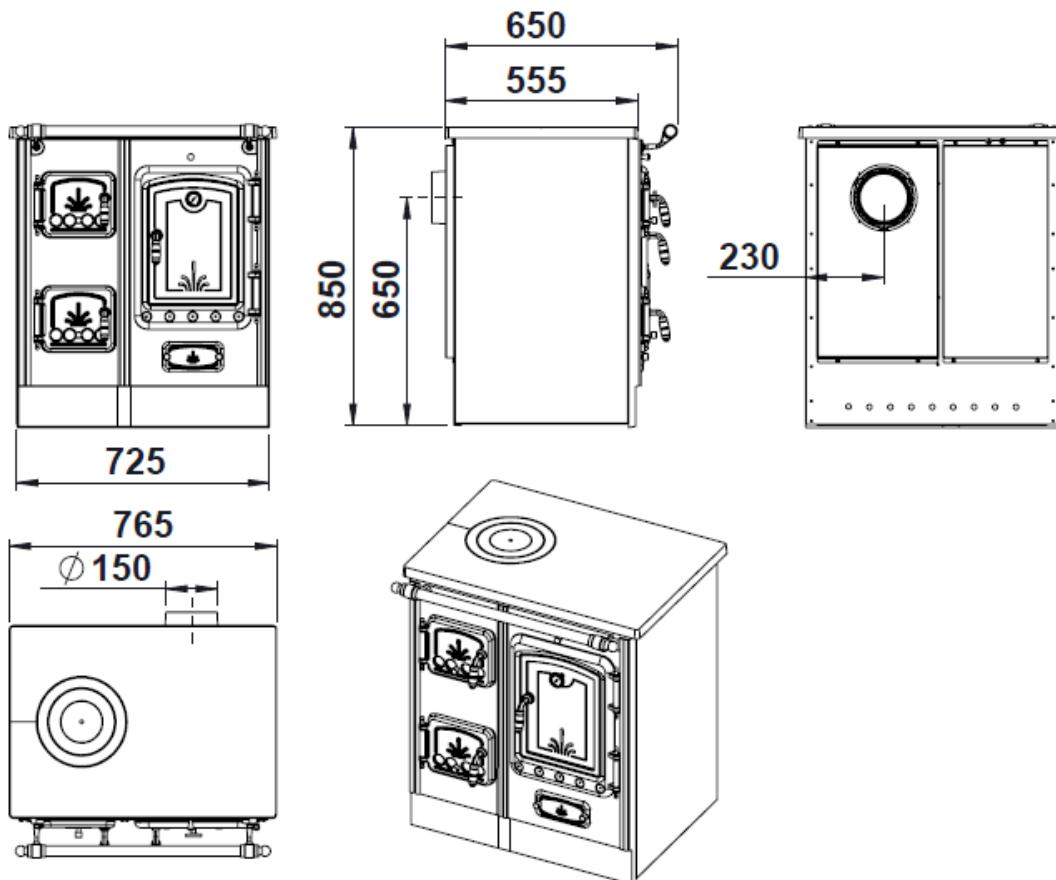
Figura n°1 - Dimensões em mm do aparelho Lis 5T
