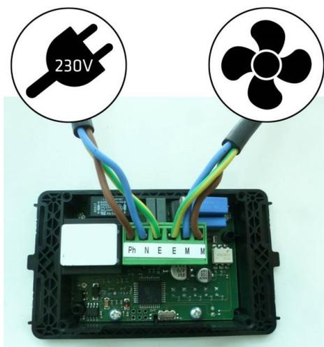
Figura nº1 - Ligações a realizar no potenciômetro
