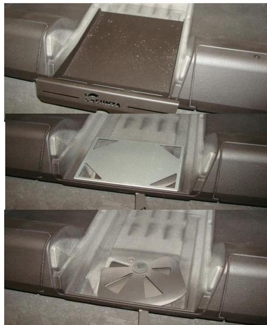
Figura nº11 - Sequência de desmontagem de peças para aceder à limpeza
