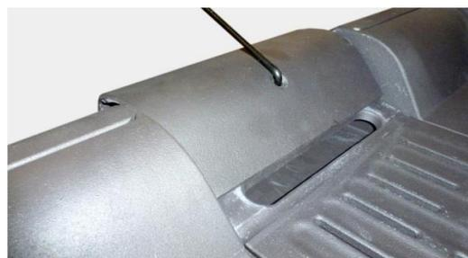
Figura nº8 - Separador deslocado para a posição de escotilha solta
