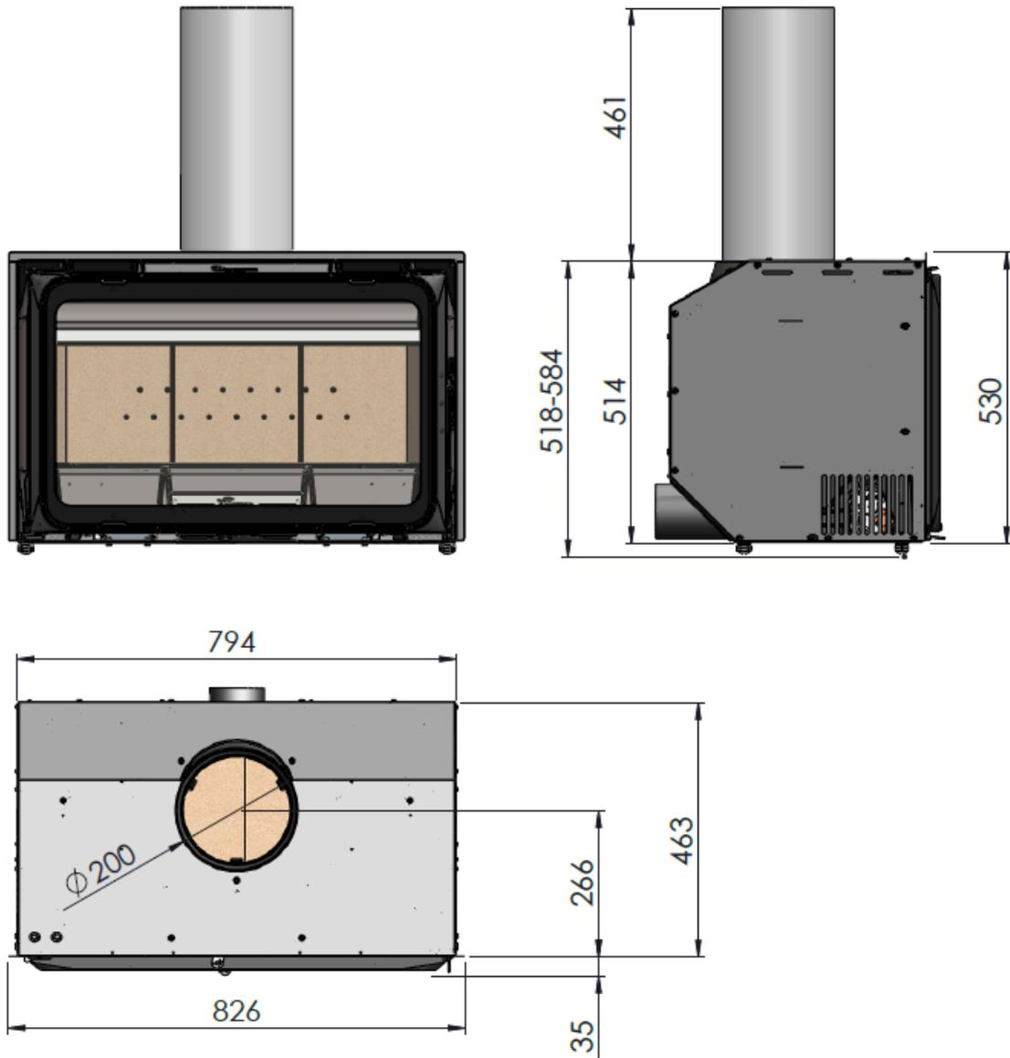
Figura nº1 - Dimensões em mm do aparelho K2-800
