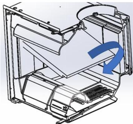
Figura nº14 - Extração dos defletores de vermiculita
