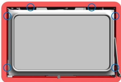
Figura nº11 - Pontos de fixação dos parafusos
