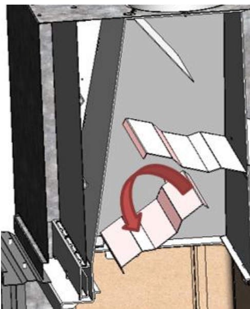
Figura nº33 - Desmontagem do defletor médio Itaca 80 eco
