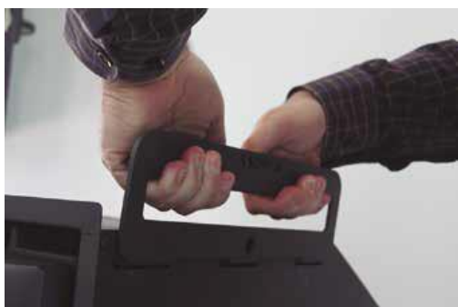
Figura nº3 - Colocação das pegas para deslocamento
