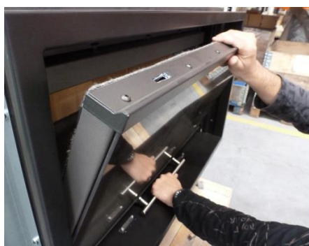
Figura nº37 - Agarra-se na porta firmemente com ambas as mãos enquanto se rebate a mesma
