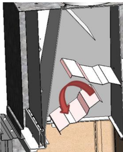
Figura nº28 - Desmontagem do defletor médio Itaca 80
