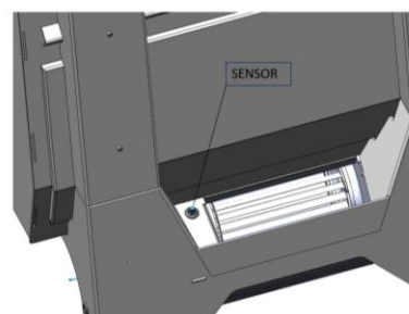
Figura n°20 - Posição da sonda de temperatura (SENSOR) na saída de ar da turbina
