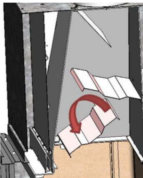
Figura nº32 - Desmontagem do defletor médio Itaca 80 eco
