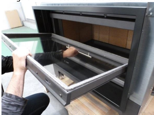
Figura nº43 - Porta completamente rebatida
