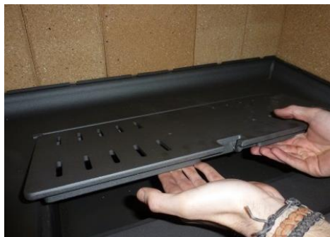
Figura n°23 - Abater a grelha com ambas as mãos
