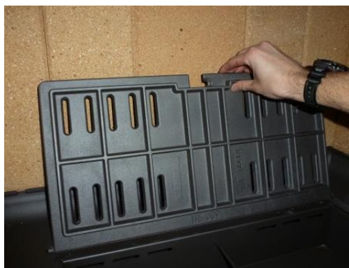
Figura n°24 - Apoiar a grelha no fundo da fornalha
