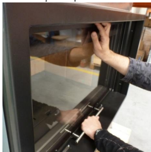
Figura nº36 - Agarrar no puxador com uma das mãos enquanto que com a outra se puxa a porta para fora.
