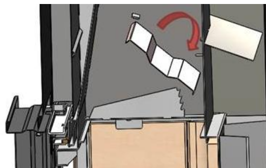
Figura nº25 - Desmontagem do defletor médio Inca
