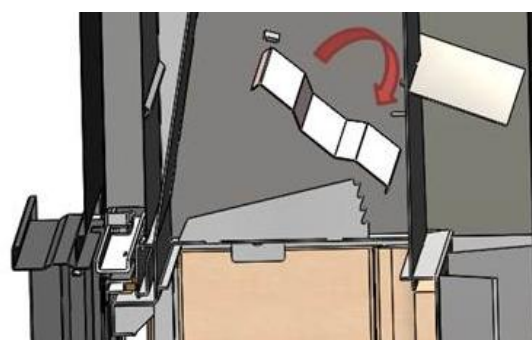
Figura nº25 - Desmontagem do defletor médio Inca
