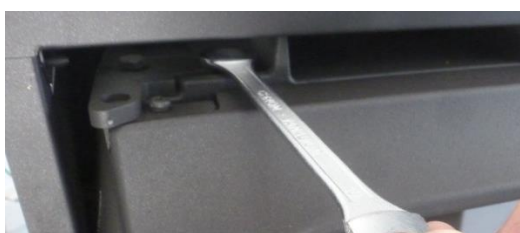
Figura nº9 - Afrouxando o suporte da porta com uma chave fixa de 10
