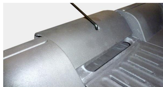
Figura nº20 - Separador deslocado para a posição de escotilha solta
