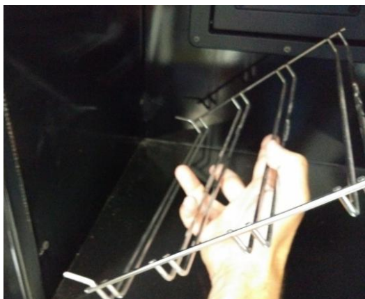
Figura nº20 - Retirada dos suportes das hastes
