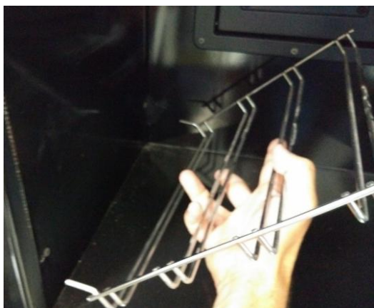
Figura nº20 - Retirada dos suportes das hastes
