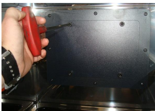
Figura nº18 - Acesso aos parafusos para retirar a tampa da escotilha
