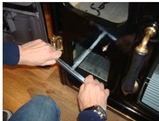
Figura nº15 - Movimento para elevar ou baixar a posição da grelha
