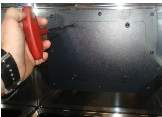
Figura n°19 - Acesso aos parafusos para retirar a tampa da escotilha
