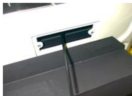
Figura n°20 - Acessos para a limpeza da saída de fumos.
