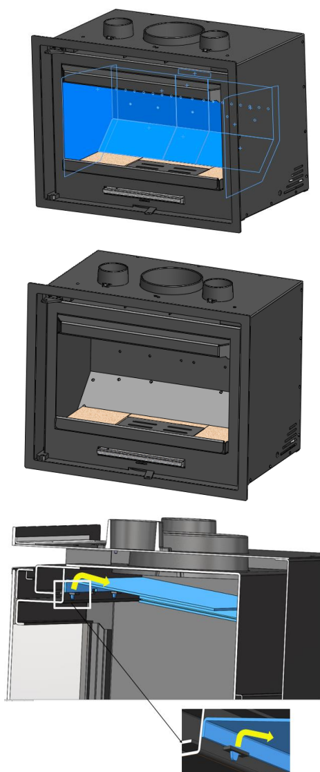
Figura nº9 - Desmontagem defletor superior
