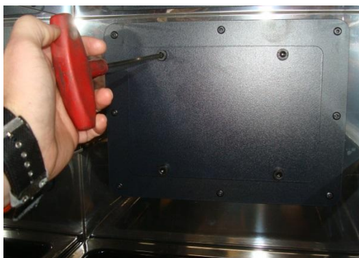
Figura n°22 - Escotilla horno abierta
