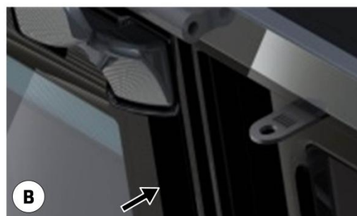
Figura n°19 - Posiciones de la palanca desvío humos en paila E5
