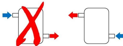
Figura nº10 - Conexión incorrecta (izda.) y conexión correcta (dcha.)
