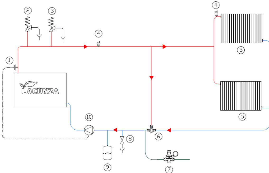
Cuando el agua de la paila alcance los 50°C el termostato (1) hará funcionar la bomba circuladora (10), hasta que la temperatura del agua descienda de dicha temperatura.
