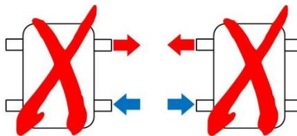
Figura nº11 - Conexiones incorrectas (menor potencia térmica al agua)
