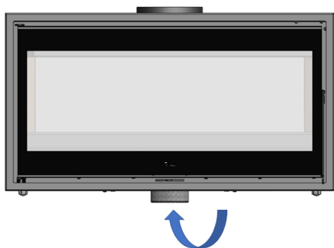
Figura nº11 - Conducción del aire para la cámara de combustión Verona 800-1000.
