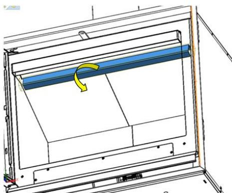
Figura nº9 - Soltar perfil de unión entre vermiculitas
