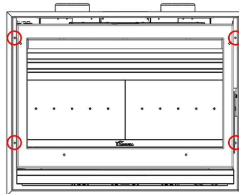
*Figura nº3 - Destornillar los 6 tornillos que amarran el marco exterior*
