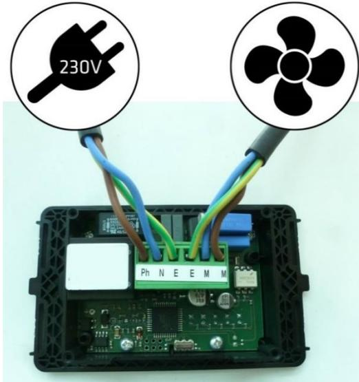
Figura nº12 - Conexiones a realizar en el potenciómetro
