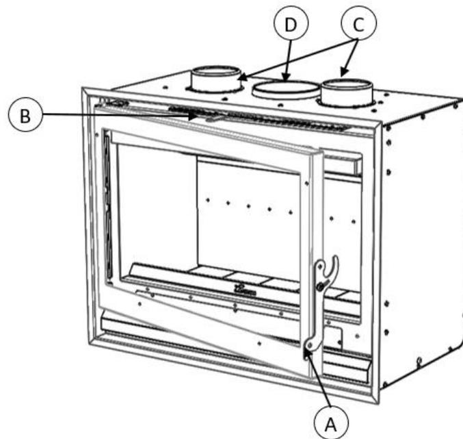
Figura nº8 - Elementos de funcionamiento del aparato
