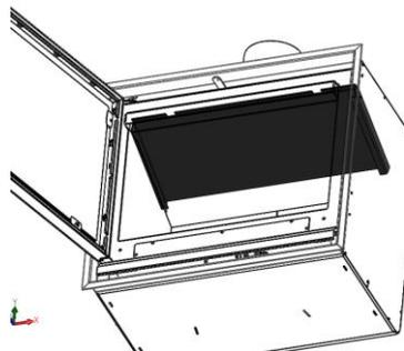
Figura nº11 - Para extraer el deflector superior debemos de extraer los laterales y traseras de vermiculita.
