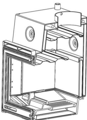
Figura nº18 - *Vista de sección con dos deflectores colocados (Sarria-Sakan Plus)*
