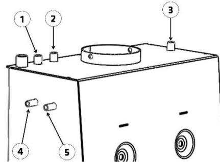
Figura nº13 - Racores de conexión en la paila
