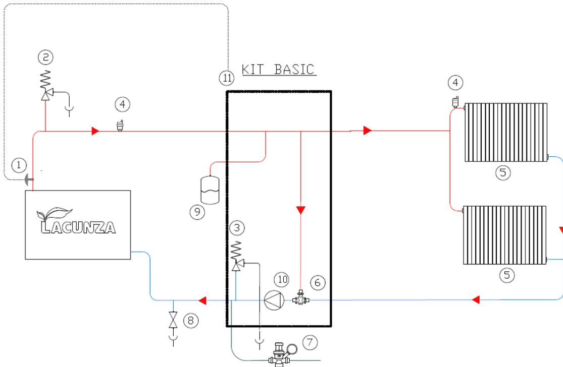
Cuando el agua de la paila alcance los 45°C el termostato (1) dará señal al regulador automático (11) y este hará funcionar la bomba circuladora (10), hasta que la temperatura del agua descienda de 43°C.
