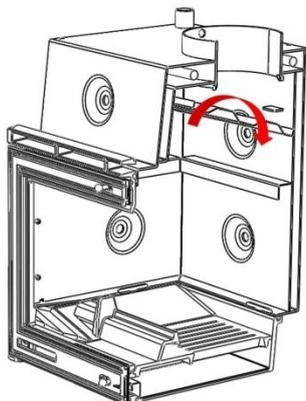
Figura nº17 - *Desmontaje del deflector superior Sarria-Sakan Plus*
