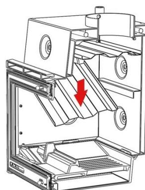
Figura nº16 - Desmontaje del deflector inferior Sarria-Sakan Plus
